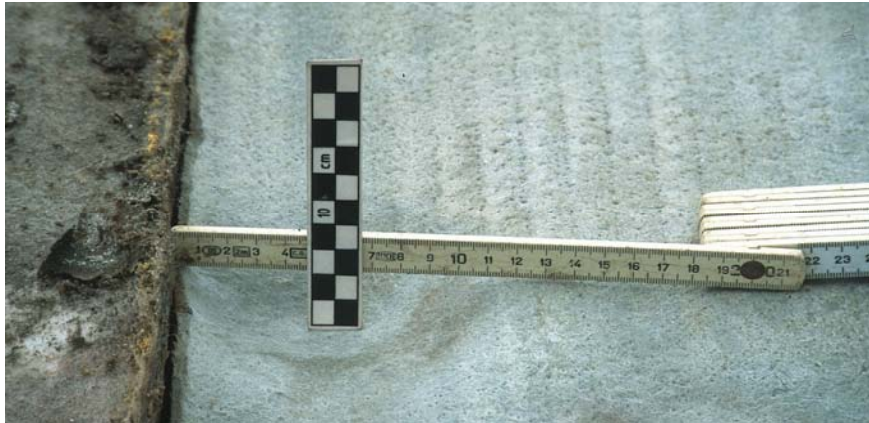
Abbildung 1: Bentonitmatte mit Eindrückung durch Wasserbausteine
