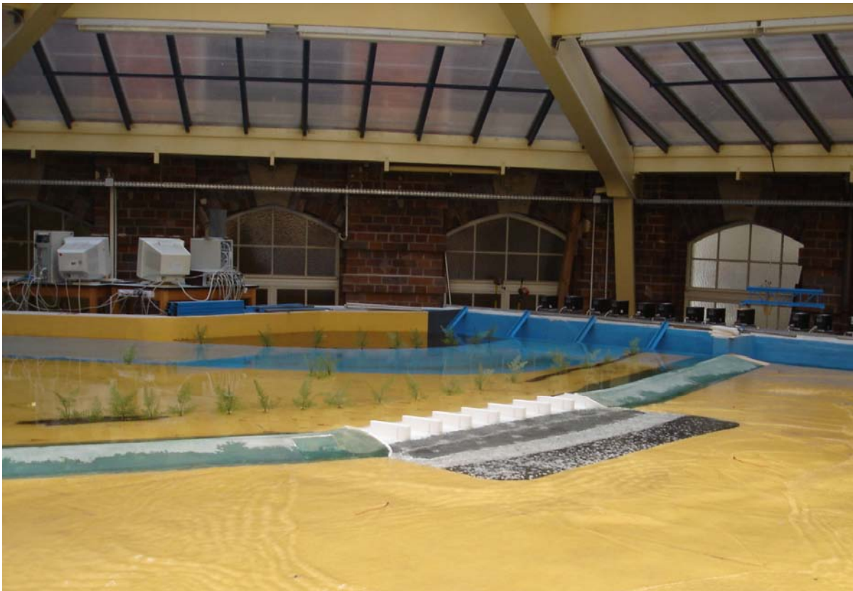
Abbildung 8: Modellversuch Einlaufbauwerk Rösa, Modellmaßstab 1:50, Stand Juni 2007
