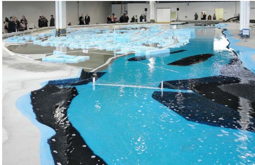
Abbildung 2: Physikalischer Modellversuch M 1:50 (Quelle: UJ K. Eckhold)
