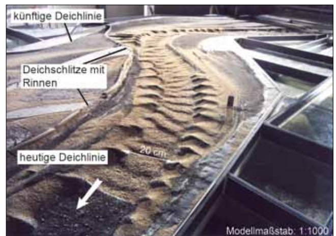
Bild 8: Sohle des Geschiebekoffers nach dem Versuch mit geschlitztem Deich (Rückdeichung A) im AD-Modell Figure 8: Bottom of the movable bed part after test with the dike with slots (dike relocation A) in the aerodynamic model
