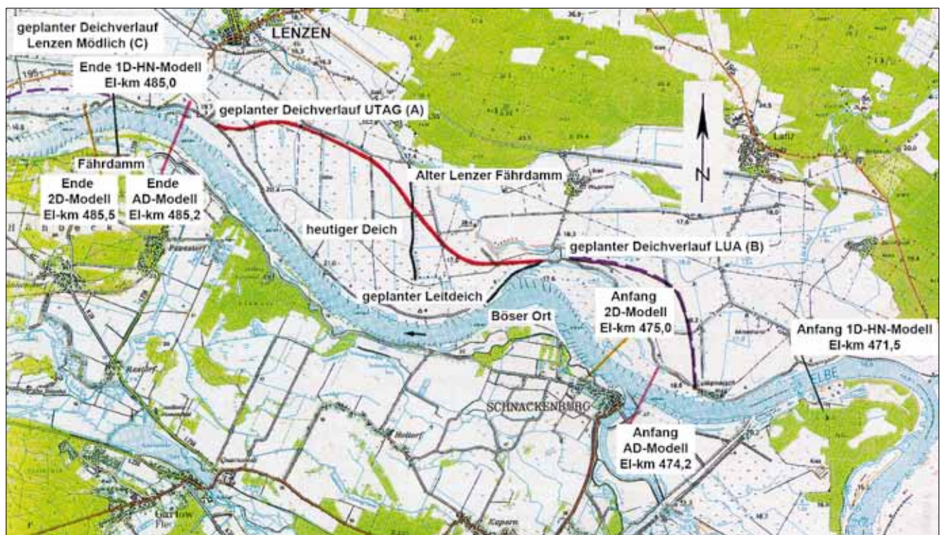
Bild 1: Rückdeichungsbereiche A bis C und Untersuchungsräume der kurzen Modelle Figure 1: Dike relocation areas A to C and study areas of the short models
