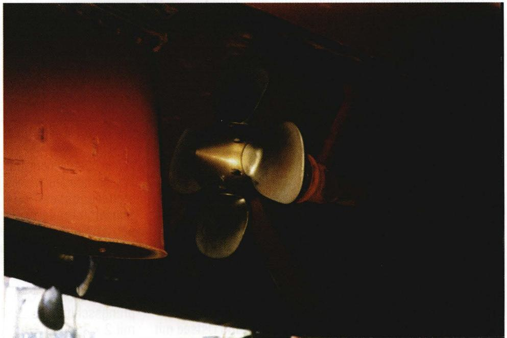
Bild 1: Verstellpropelleranlage des Eisbrechers „Fürstenberg“ (Umbau 1997)
