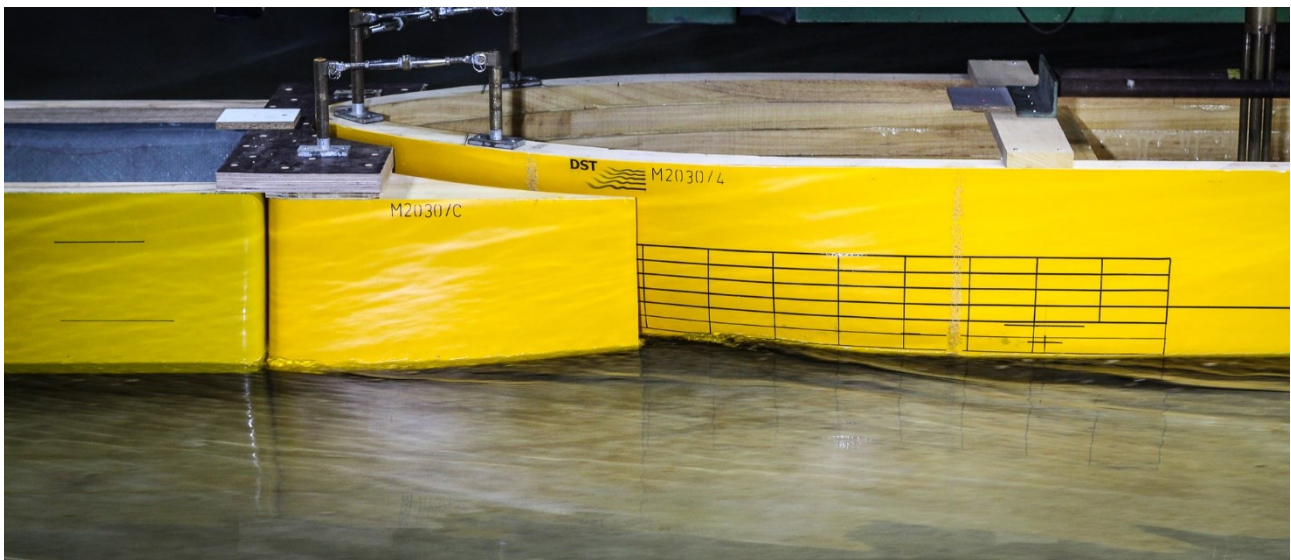
Bild 1: Die Koppelstelle des Neckarschiffs mit einem Leichter im Modellmaßstab 1:16 im Schlepptank des DST
