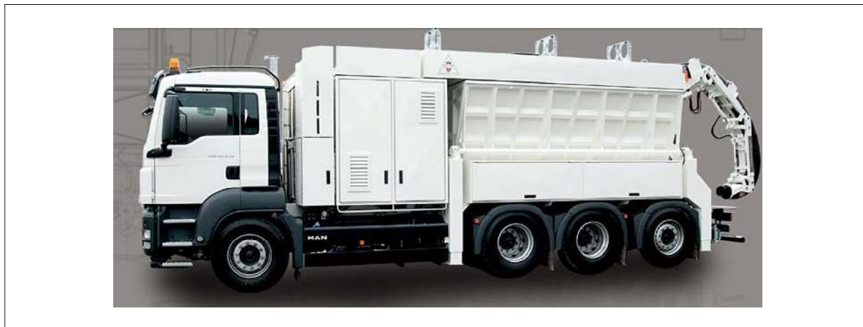
Abb. 71: Darstellung eines Saugfahrzeuges, hier: RSP ESE 32 (nach RSP 2014a)
