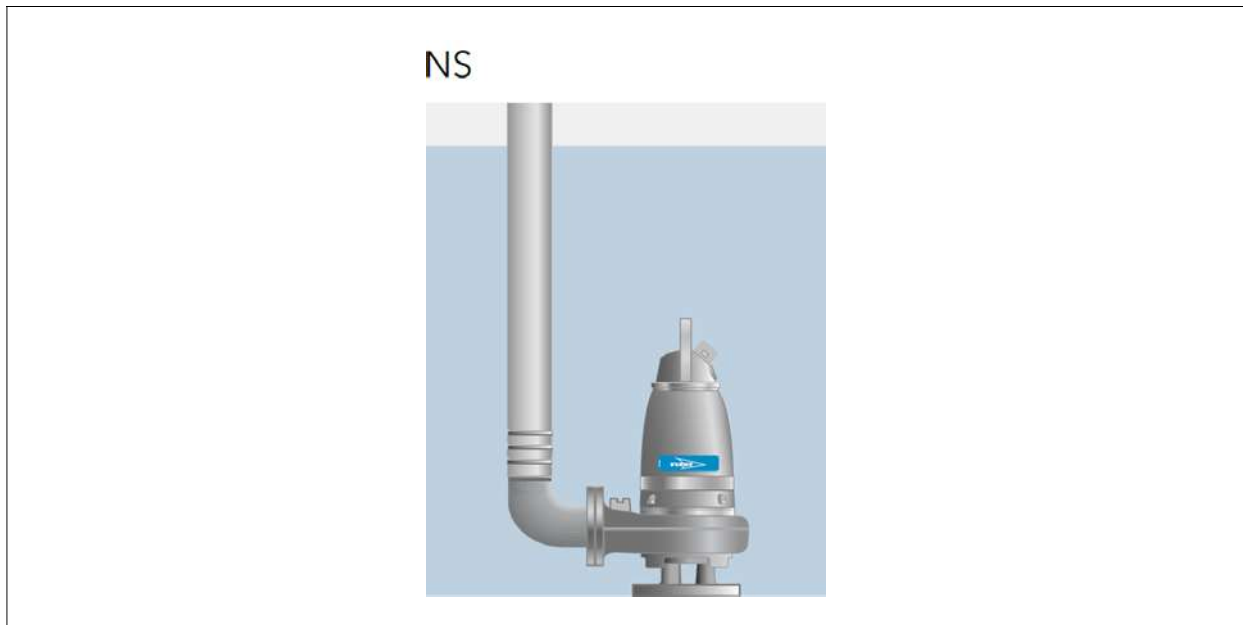
Abb. 59: Darstellung der Pumpe Xylem Flygt 3301 in transportabler Nassaufstellung = NS (nach FLYGT 2014c, S. 8)
