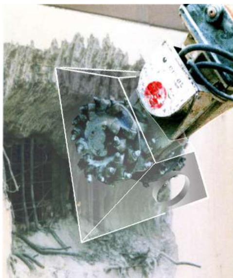
Abb. 4.1.: Prinzip einer Fräseinrichtung mit Sammelbehälter und Absaugöffnung.
