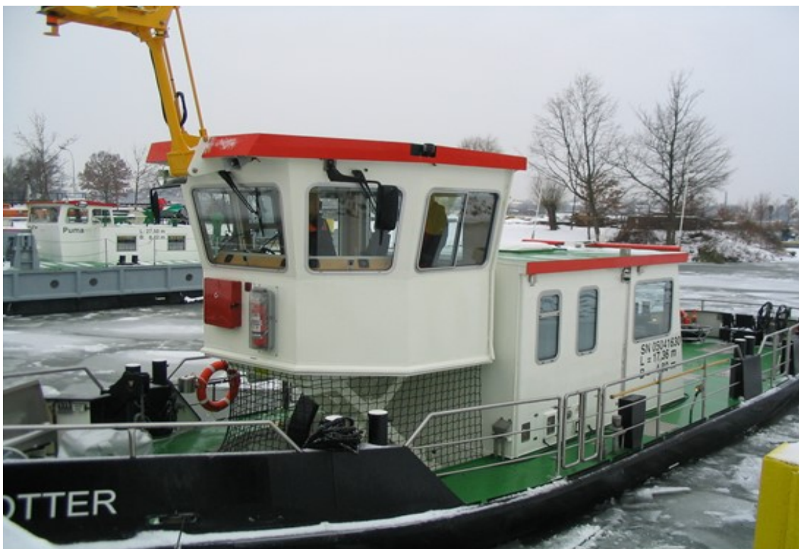
Abbildung 4: Test höhenverstellbares Steuerhaus auf Scherenhubtisch bei Abnahme 2009
