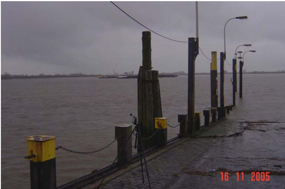
Abbildung 15: Messung der durch den Schiffsbetrieb verursachten Schallimmission am Ufer einer Wasserstraße
